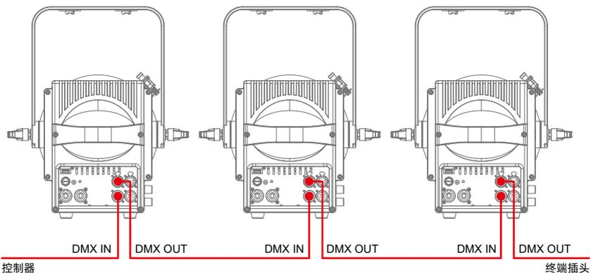
使用一条屏蔽双绞信号线从控制器的 DMX 输出口连接到第一台设备的 DMX 输入口，并从第一台设备的 DMX 输出口连接到第二台设备的 DMX 输入口，依此类推，直到将所有的灯具连接完毕，然后在每一连路的最后一个连接灯具输出 3 芯插孔上安装一个终端插头。（在 3 芯带针卡侬插头的 2、3 插针之间焊接一个 4/1W、120Ω 的电阻）。
